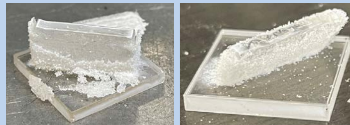
Abb.4 links: gelöster Pulverpartikelrand einer gerade aufgebaute Probe & rechts: Pulverpartikelrand einer schräg aufgebauten Quarzglasprobe
