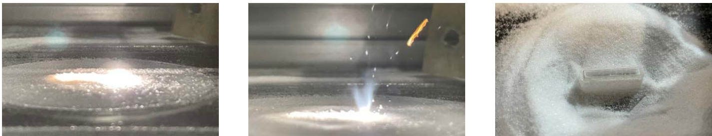
Abb.3 links: Lasern der Schmelzspur; Mitte: Pulverflug bei Randbearbeitung; rechts: Probe im Pulverbett nach dem Bauprozess
